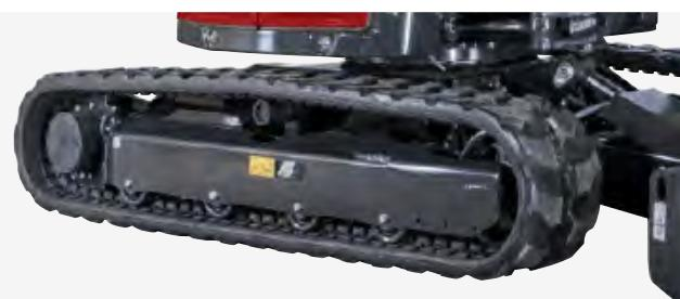
La struttura ad "X" con sezioni scatolate garantisce un'eccellente rigidità torsionale. Il telaio è progettato per la massima durabilità.
