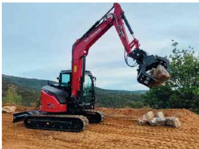
Il modello SV86-7 è dotato di due circuiti idraulici ausiliari di serie ma può essere anche equipaggiato con un terzo circuito idraulico ausiliario opzionale. Il controllo proporzionale (tramite joystick) consente di regolare con precisione la portata idraulica mentre si lavora.. La possibilità di impostare e salvare sul display la portata dell'olio per un massimo di 5 attrezzi consente all'operatore di adattare facilmente
