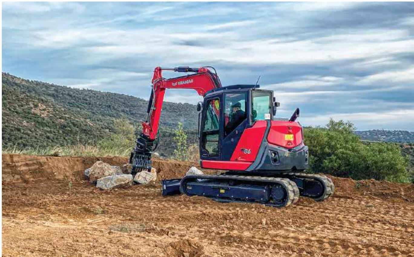
Il nuovo design dell'escavatore Yanmar SV86-7 garantisce affidabilità, robustezza e resistenza nel tempo. Il design del sottocarro e i pesanti rivestimenti in acciaio proteggono in modo efficace il telaio dai danneggiamenti quotidiani. Le forme innovative e l'estrema compattezza facilitano il lavoro anche in ambienti ristretti senza rinunciare alle prestazioni e alla stabilità nelle operazioni di sollevamento.
