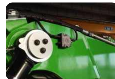
Inclinometri sul BOOM e STICK (solo per Escavatori a tre bracci)
