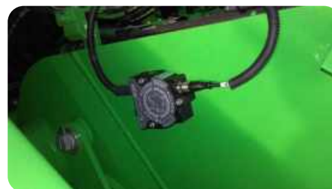
Inclinometri sul BOOM e STICK (solo per Escavatori a tre bracci)
