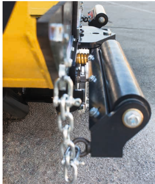
Appoggio senza colpi – barra di spinta ammortizzata.
