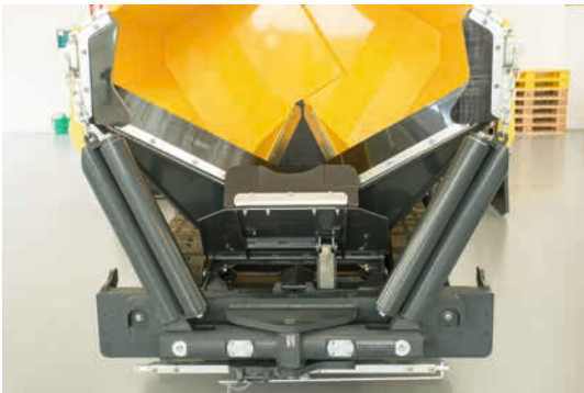
Sponda frontale idraulica – per un flusso omogeneo del materiale.
