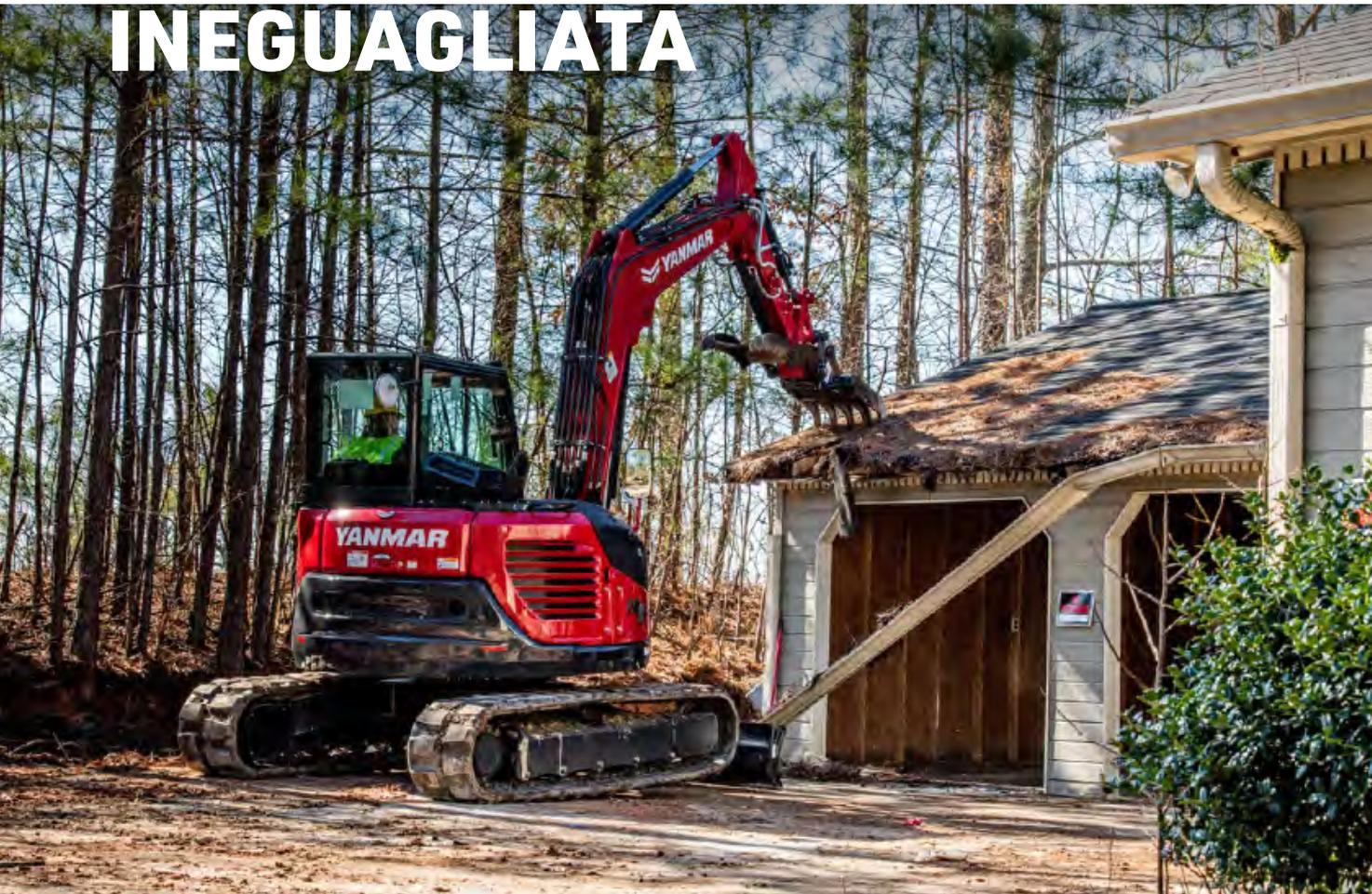
Il ViO80-1 offre le prestazioni di un escavatore di classe "large" mantenendo tutti i vantaggi di un escavatore compatto. Particolarmente idoneo per lavori in aree urbane consente di manovrare con estrema tranquillità ed efficienza a fianco di muri ed in spazi limitati dove altre macchine della stessa classe di peso non avrebbero accesso.
