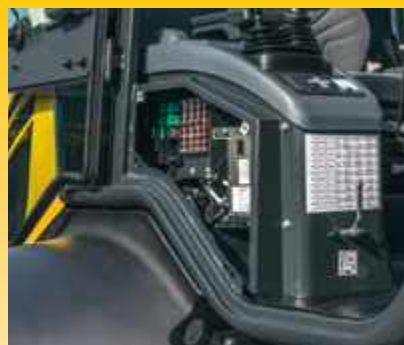
Cofano laterale per rapide operazioni di manutenzione
