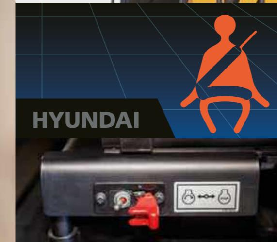
**Avviso agli operatori di allacciare la cintura di sicurezza** tramite un **allarme acustico** e visivo.
