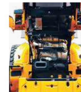
Il **cofano motore** è completamente **retrattile** e può essere **aperto elettricamente** per un accesso agevolato al vano motore e al vano di raffreddamento sigillati. Il vano motore è progettato per prevenire il rischio di incendi causati dall'afflusso di materiale esterno.
