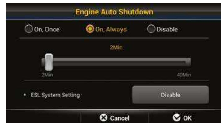
Per tagliare il consumo di carburante ed evitare emissioni inutili, il **motore si spegne automaticamente quando la macchina è a riposo**. L'efficienza può essere ulteriormente migliorata selezionando diverse modalità operative e tempi per lo spegnimento automatico del motore in base allo specifico ambiente di lavoro.
