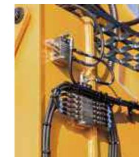
Con il **sistema di ingrassaggio automatico** optional, il grasso è applicato automaticamente ai punti di lubrificazione quando ce n'è bisogno. Il dosaggio corretto è garantito e il lubrificante è applicato uniformemente con conseguente riduzione del consumo di grasso ed eliminazione degli sprechi.
