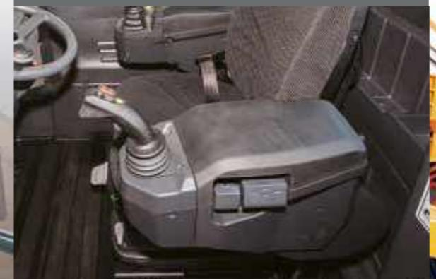
HL960A ha come standard un **sedile ampio e confortevole** dotato di riscaldamento. Il sedile e il bracciolo sono completamente regolabili e, per maggior comfort, è disponibile come optional la sospensione pneumatica. Grazie alla **leva di comando elettrico-idraulico integrata**, è richiesto minor sforzo per azionare gli attrezzi ed è pertanto possibile lavorare più a lungo e più produttivamente.
