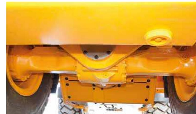
Gli **assali** dell'HL960AHD sono progettati per l'affidabilità senza compromessi nel lavoro heavy-duty continuo. Nonostante la grande stabilità e capacità di trasmissione della potenza, l'assale del caricatore gommato ha un disegno compatto ed è a basso peso. I freni multi-disco bagnati sono meno soggetti al "fading" e pertanto favoriscono l'efficienza.
