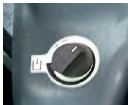
3 Regolazione della portata massima tramite potenziometro
