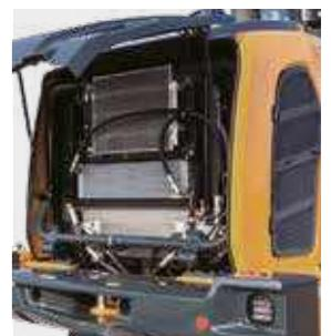
HL970A è dotato di un affidabile **radiatore ad aria ad ampio nucleo e ad alette** che previene la degradazione delle prestazioni causata dalla contaminazione.
