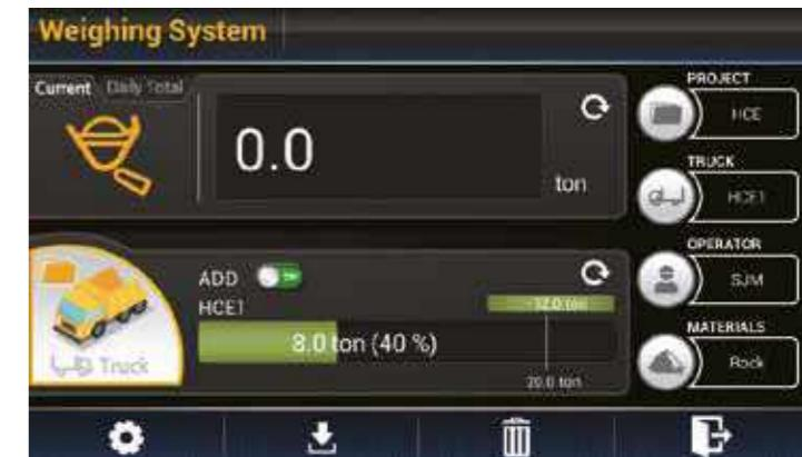
Il **sistema di pesatura cumulativa di precisione automatica/manuale** aiuta a gestire la produzione con maggiore efficienza in qualsiasi ambiente. Per la massima precisione, il monitor visualizza icone di errori di pesatura e un indicatore del valore del peso a due colori.
