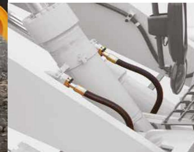
L'impianto idraulico è stato semplificato con un **sistema a valvola di comando unificata**. Questa soluzione elimina l'esigenza di flessibili idraulici collegati a ogni valvola e riduce il numero di potenziali punti di perdita.
