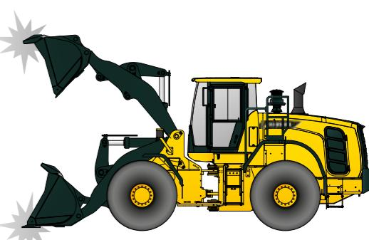
La funzione di **arresto con smorzamento al finecorsa** riduce la velocità idraulica del cilindro in prossimità del finecorsa. Allevia il carico d'urto al finecorsa, aumenta il comfort dell'operatore e migliora la capacità di trattenere il materiale.
