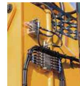
Con il **sistema di ingrassaggio automatico** optional, il grasso è applicato automaticamente ai punti di lubrificazione quando serve. Il dosaggio corretto è garantito e il lubrificante è applicato uniformemente con riduzione nel consumo del grasso ed eliminazione degli sprechi.
