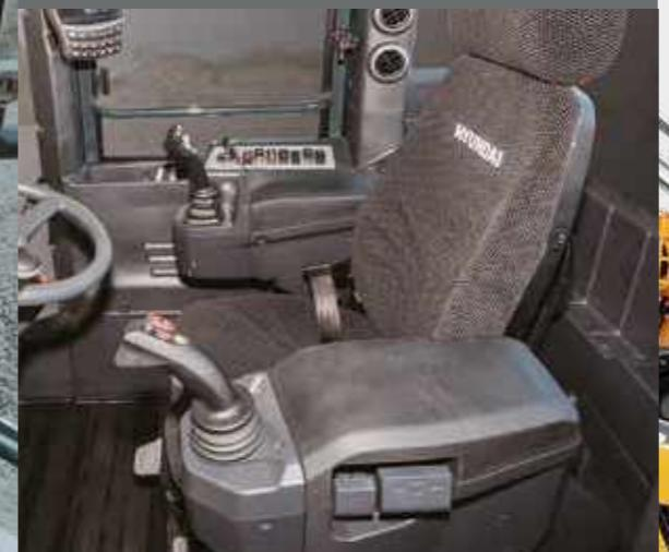
HL970A ha un **ampio sedile confortevole con sospensione pneumatica** dotato di riscaldamento come standard. Sedile e bracciolo sono completamente regolabili.
