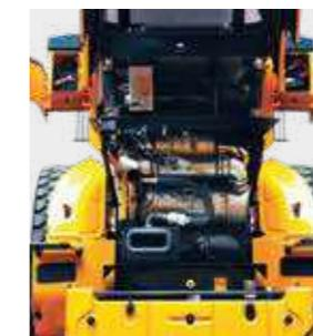
Il **cofano motore inclinabile all'indietro** è completamente retrattile e può essere aperto elettricamente per un accesso agevole a vano motore e di raffreddamento sigillati. Il vano motore è progettato per prevenire il rischio di incendi causati dall'afflusso di materiale esterno.
