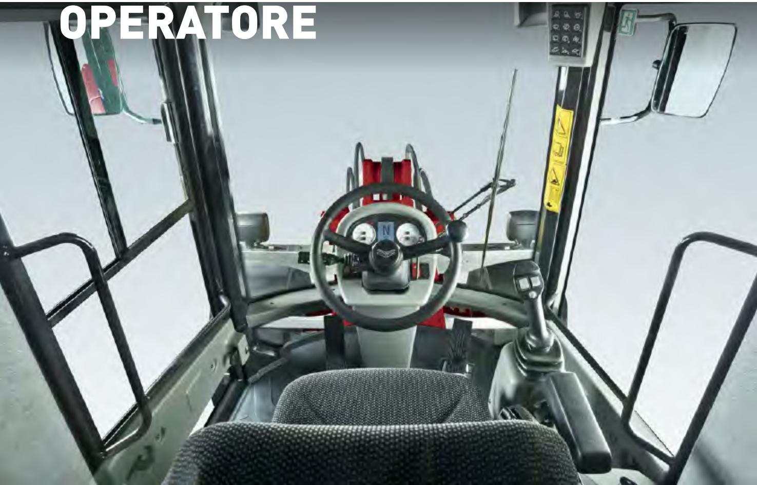
Progettata per il comfort dell'operatore e la massima produttività, la cabina dotata di sistemi d'abbattimento del rumore e smorzamento delle vibrazioni ed è omologata ROPS/FOPS.
