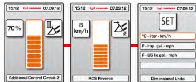
Regolazione proporzionale con comando elettrico delle portate idrauliche del 3° e 4° circuito.
