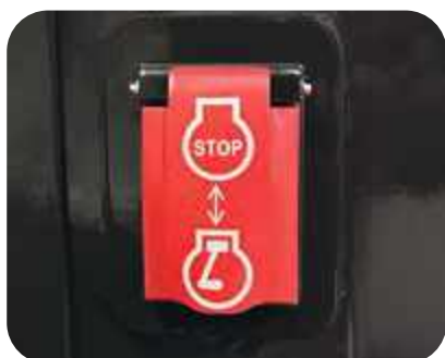
Interruttore secondario di arresto motore
