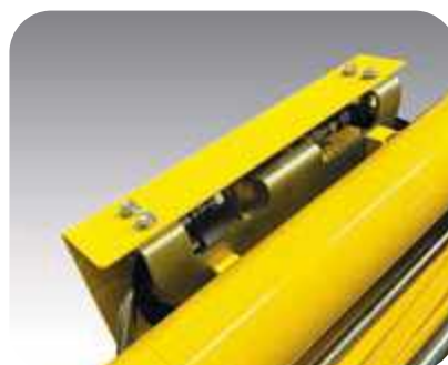
Valvole di sicurezza cilindri braccio e avambraccio
