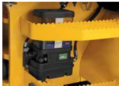
Impianto di lubrificazione centrale
