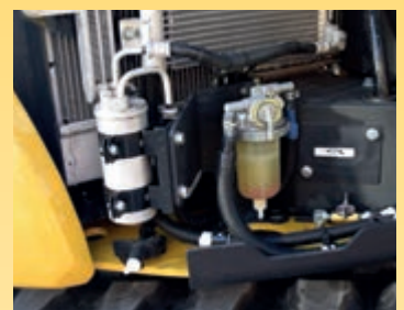
Grande filtro e prefiltro del carburante con separatore di acqua per proteggere il motore
