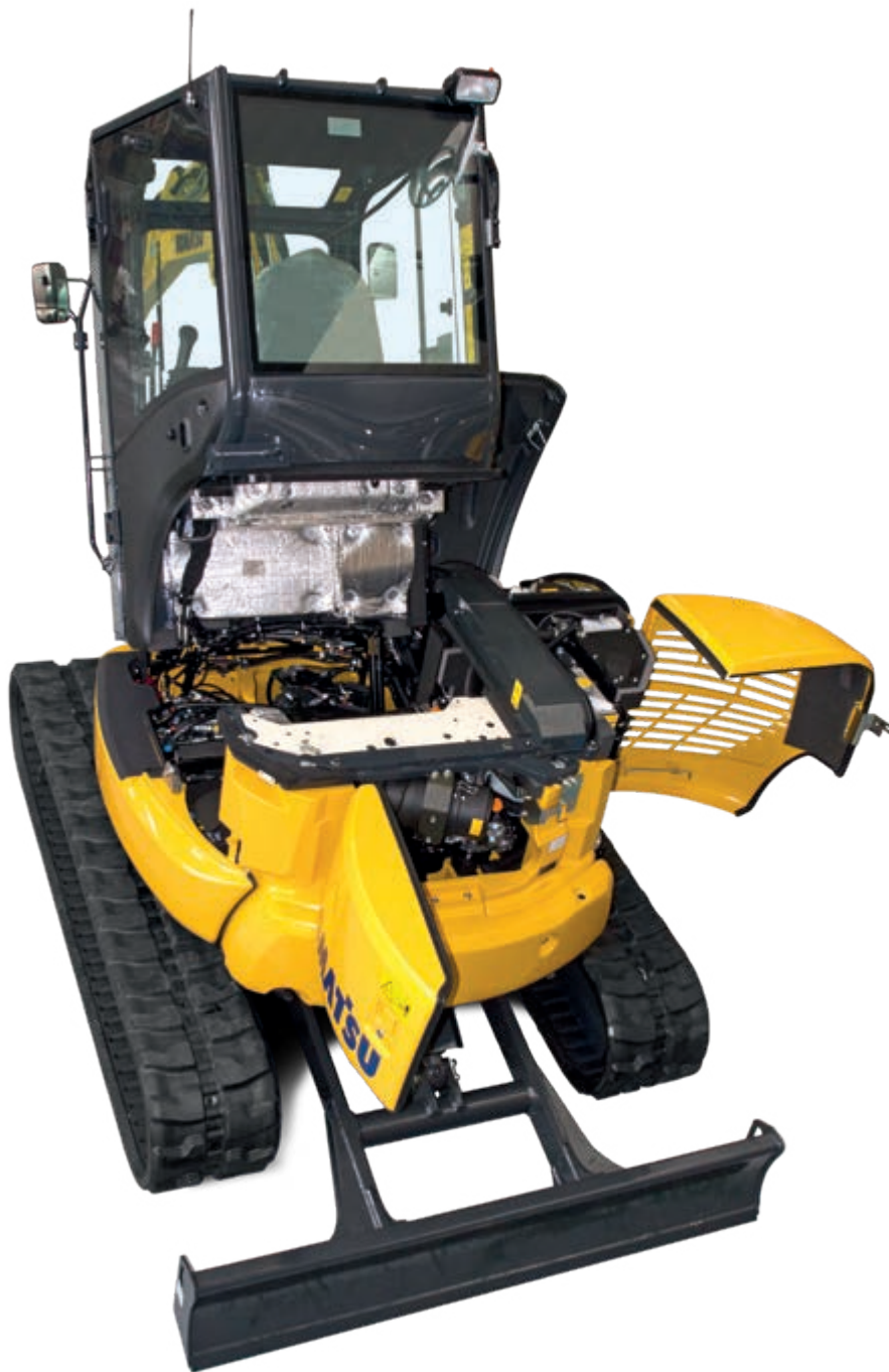
Cofani posteriori per controllo del motore, rifornimento carburante, ispezione e pulizia dei radiatori ed accesso alla batteria
