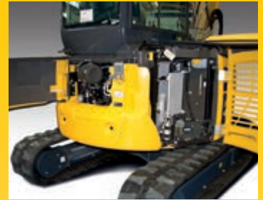
Cofani posteriori per controllo del motore, rifornimento carburante, ispezione e pulizia dei radiatori ed accesso alla batteria
