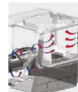
L'**impianto dell'aria condizionata** è installato sul lato destro della cabina da dove può essere comodamente raggiunto per le operazioni di manutenzione e la sostituzione del filtro. Integra un filtro interno ad alta capacità e il materiale di filtraggio è stato scelto con cura per garantire le migliori prestazioni.
