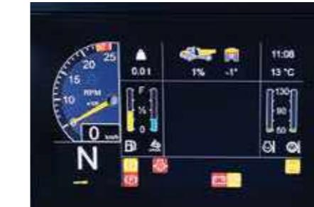
Il display multifunzionale di assistenza e manutenzione semplifica il controllo del livello olio cambio, anche dei componenti idraulici ed elettronici.
