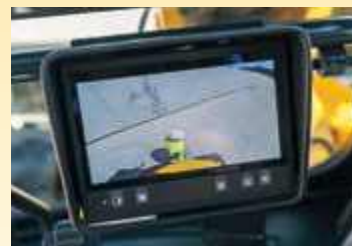
Telecamera posteriore (versione cabina)
