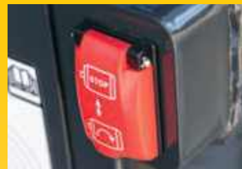
Interruttore secondario di arresto motore
