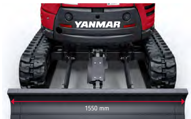
Esteso: incremento di stabilità per garantire migliori prestazioni di scavo e carico
