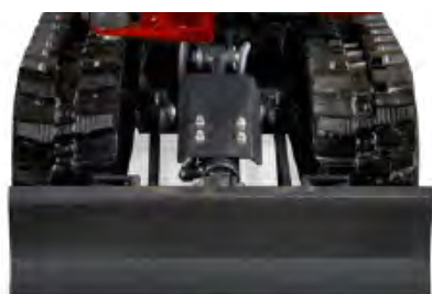
Sottocarro contratto, 680 mm : facilità di manovra
