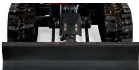
Sottocarro esteso, 840 mm : maggiore stabilità
