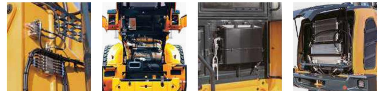
Con il **sistema di ingrassaggio automatico** optional, il grasso è applicato automaticamente ai punti di lubrificazione quando serve. Il dosaggio corretto è garantito e il lubrificante è applicato uniformemente con riduzione nel consumo del grasso ed eliminazione degli sprechi.
