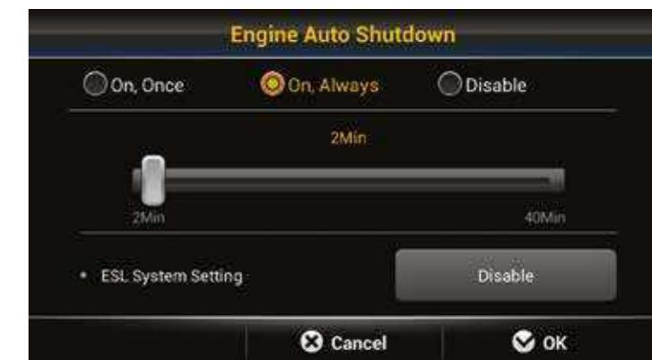
Per tagliare il consumo di carburante ed evitare emissioni inutili, il **motore si spegne automaticamente quando la macchina è a riposo**. Per aumentare ulteriormente l'efficienza, possono essere selezionate diverse modalità operative e tempi al minimo in base all'ambiente di lavoro.
