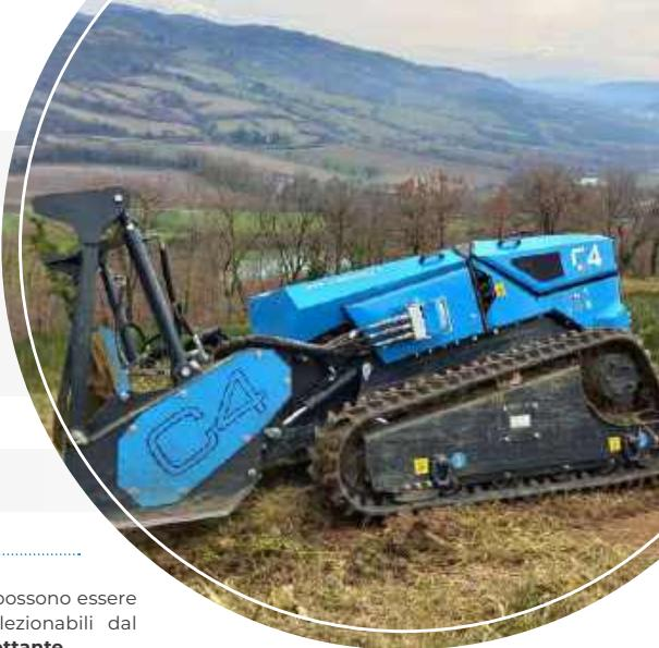
Il **sollevatore** utilizza due cilindri oleodinamici che possono essere configurati in 3 modalità di funzionamento, selezionabili dal radiocomando: **doppio effetto / singolo effetto / flottante**.
